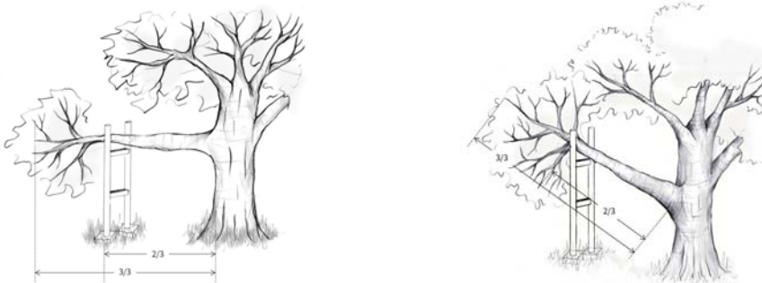
H형 지지대 - 어느 정도 지지능력이 있고 수평에 가까운 가지 지지 (가지의 움직임 고려)
