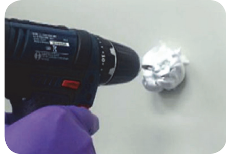
면도크림을 이용한 구멍 뚫기
