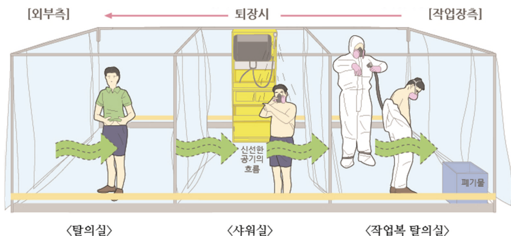
[그림 16] 위생설비 설치 및 사용
