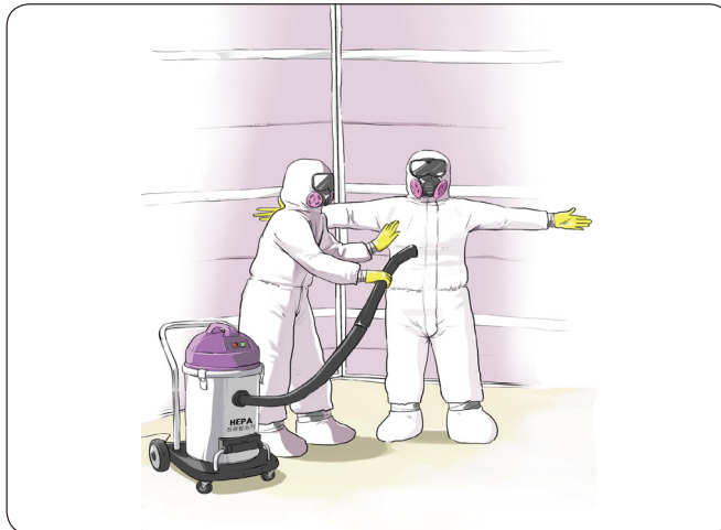
[그림 15] 작업장 이동 전 석면분진 세척모습
