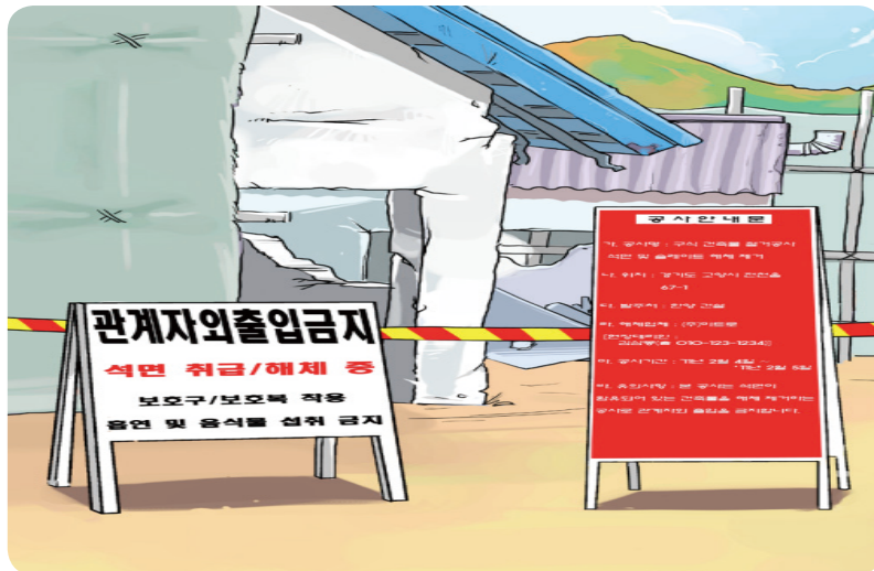
[그림 5] 석면해체·제거 작업장 바리케이트 및 경고표지 설치 예
