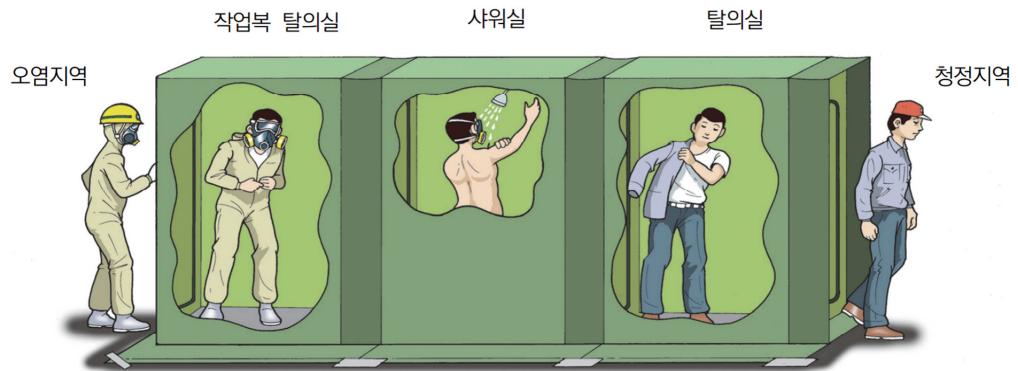
[그림 16] 위생설비 설치 및 사용
