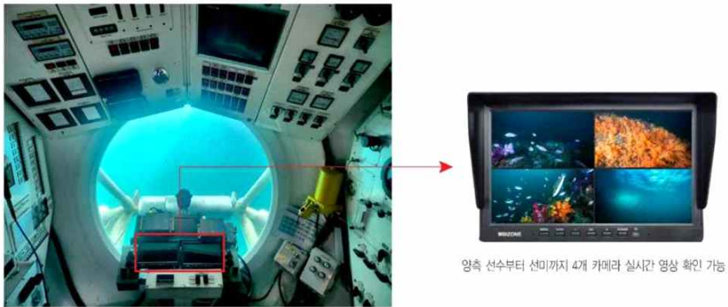
그림4_조타실 모니터 설치 모습
